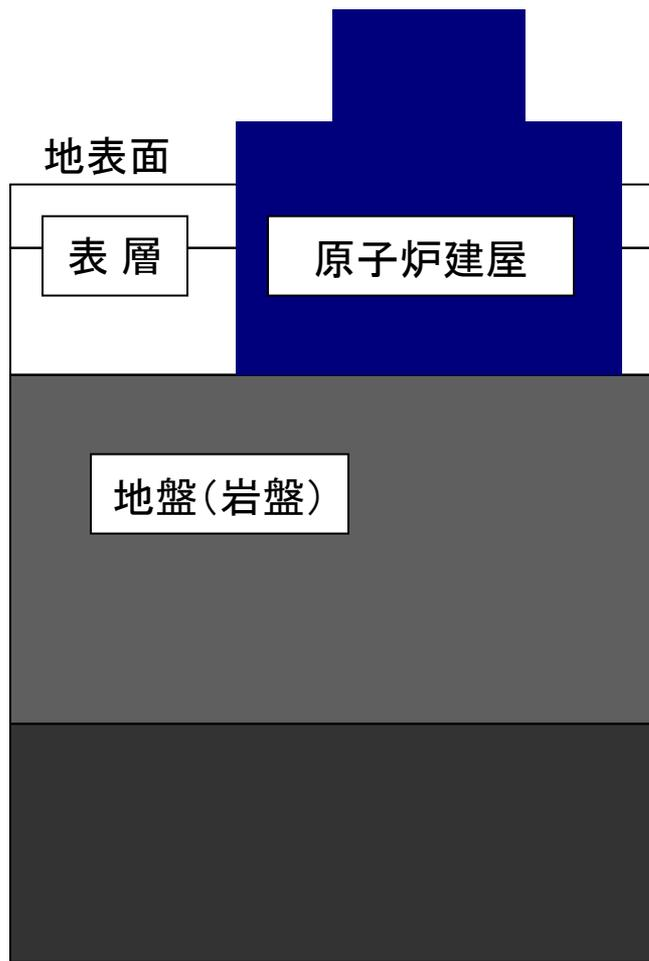
「解放基盤表面」とは、基準地震動を策定するために、基盤面上の表層や構造物が無いものとして仮想的に設定する自由表面であって、著しい高低差がなく、ほぼ水平で相当な広がりをもって想定される基盤の表面をいう。ここでいう「基盤」とは、概ねせん断波速度 $V_s=700\text{m/s}$ 以上の硬質地盤であって、著しい風化を受けていないものとする。
